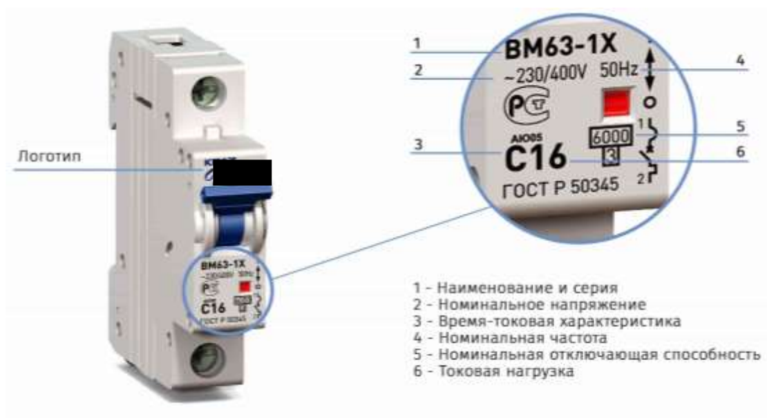
Рисунок 2. Пример маркировки АВ
